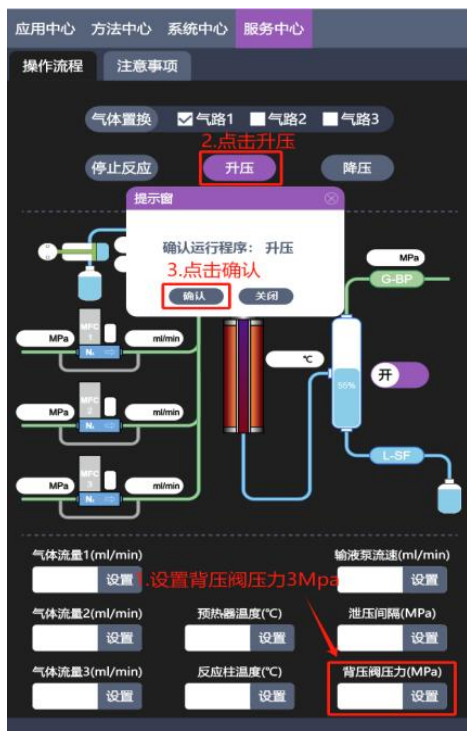
4-7 升压操作界面
