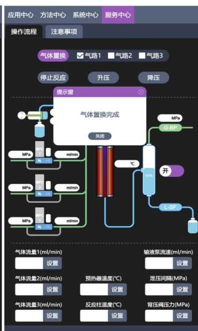
4-4 气体置换完成界面
